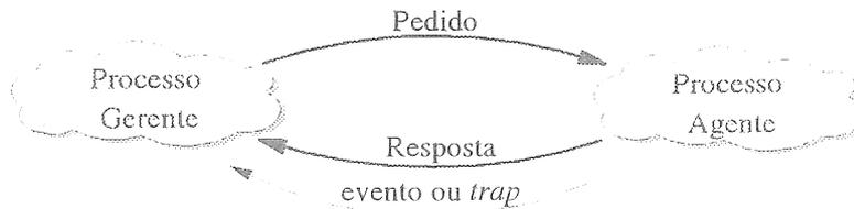
Fig. 2 - Modelo agente, gerente implementado no protocolo SNMP.
